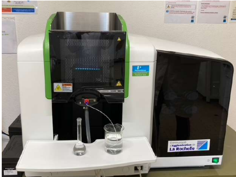
Figure 9 : Spectromètre d'absorption atomique à flamme (SAA), dispositif de PerkinElmer
